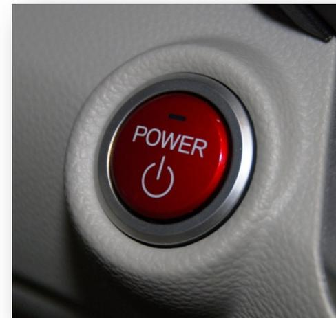
*Maintenez enfoncé le bouton marche/arrêt du moteur (« Engine Start/Stop ») pendant trois secondes.*
