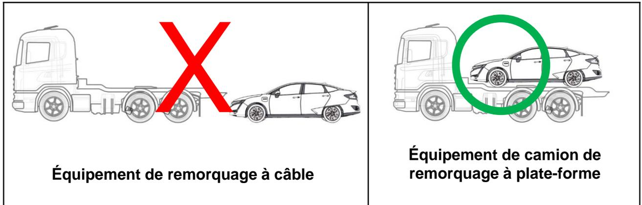
Il est important de savoir que lorsqu'un modèle Honda Clarity hybride rechargeable est déplacé avec les roues (motrices) avant au sol, le moteur électrique peut produire de l'électricité et le risque potentiel de décharge électrique persiste, même si le système haute tension est désactivé.
