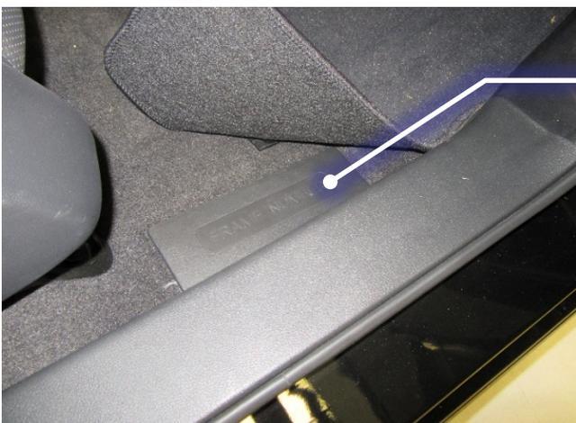
Estampé au plancher, à l'avant du siège du passager, sous le couvercle de plastique portant la mention **FRAME NUMBER**
