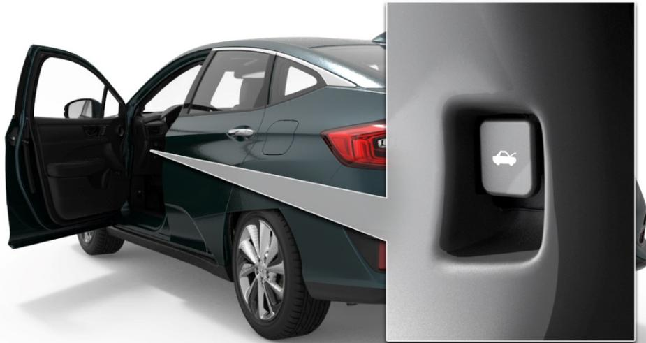
2. Repérez la détente d'ouverture du capot, poussez la détente et soulevez le capot.
