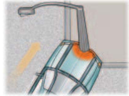
S'écraser de plein fouet sur un poteau ou un arbre risque moins de provoquer le déploiement des coussins que si vous frappez l'objet de façon décentrée, à côté de l'ossature métallique rigide de la voiture.
