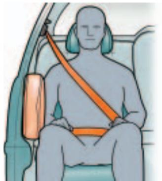
Les coussins gonflables latéraux permettent au conducteur ou au passager avant de se protéger la partie supérieure du torse.
