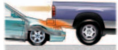
Lorsqu'une voiture s'encastre sous une autre à faible vitesse, le choc n'a d'effet que sur les parties déformables de la carrosserie et les coussins gonflables avant ne se déploient que rarement.
