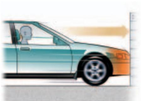
Dans une collision frontale à 48 km/h sur un mur, il faut environ 1/10<sup>e</sup> de seconde à la voiture pour s'arrêter – moins qu'un clignement d'œil. Qu'arrive-t-il aux occupants dans cet intervalle de temps ?
