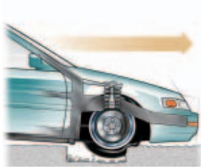
Si une roue se prend dans un nid de poule ou si vous passez sur un objet dur en relief par rapport à la route, comme un trottoir ou une bosse de ralentissement, un taux rapide de décélération peut provoquer le déploiement des coussins gonflables avant.
