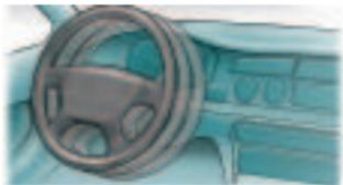
Une colonne de direction télescopique, des commandes aérodynamiques ou en retrait, des matériaux qui absorbent l'énergie, tout cela concoure à réduire les lésions en cas d'accident.
