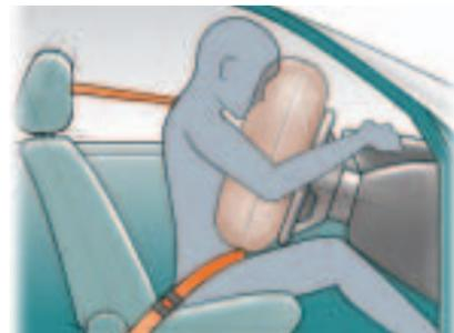
Les coussins gonflables avant offrent un surcroît de protection pour la tête et le torse des occupants des sièges avant.
