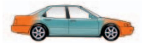
Les points d'écrasement sont conçus pour s'enfoncer et absorber l'énergie dans une collision avant ou arrière.
