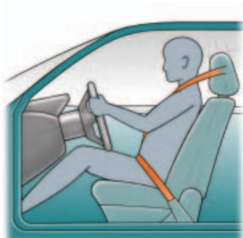
Boucler sa ceinture de sécurité, être assis bien droit, à au moins 25 cm (10 pouces) du volant de direction ou du tableau de bord, atténuent les risques de blessures causées par un coussin gonflable avant ou latéral qui se déploie.
