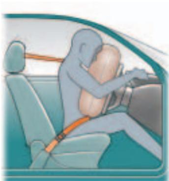
Par contre, si l'occupant a bouclé sa ceinture, cette dernière le retient et diminue les risques de blessures. Un coussin gonflable avant protège de surcroît la tête et le torse.
