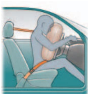
Lorsque les capteurs détectent un choc frontal de force modérée à grave, les coussins gonflables se déploient instantanément pour protéger la tête et le torse des occupants avant.
