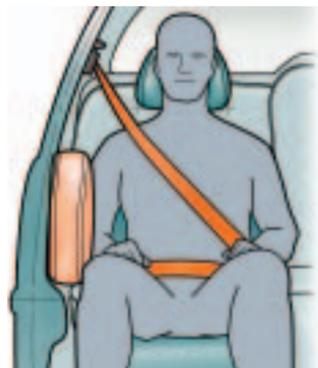
Si le choc est modéré à grave, le coussin gonflable latéral du côté de l'impact se déploie du support lombaire externe pour protéger la partie supérieure du torse de l'occupant.
