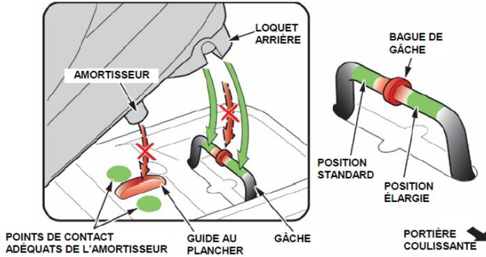
Vérifiez que le siège est verrouillé en balançant le siège d'en avant en arrière en tentant de l'incliner vers l'avant, et en veillant à ce que les loquets intérieurs et extérieurs soient verrouillés et que les crochets avant du siège soient sous les loquets avant.
