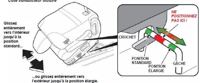
3. Abaisser la partie arrière du siège. Il y a un guide sur le plancher et une bague sur la gâche arrière en métal. Vérifiez que la gâche arrière et l'amortisseur sont du côté intérieur ou extérieur du guide et de la bague (identifiés par la couleur verte dans l'illustration) :
