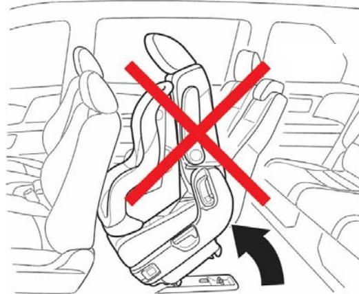
Honda ne recommande pas l'utilisation de cette méthode pour accéder aux sièges de la troisième rangée. Lorsque le siège latéral de la deuxième rangée est incliné vers l'avant, le siège peut glisser dans l'espace entre les positions standard et élargie qui empêche le siège de s'enclencher. Par conséquent, l'utilisation de cette méthode d'accès augmente le risque qu'un siège latéral de la deuxième rangée ne soit plus sécuritaire.
