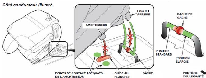
4. Poussez la partie arrière du siège vers le bas pour fixer les deux loquets arrière. Les loquets émettent un déclic lorsqu'ils s'enclenchent dans les gâches du plancher.
