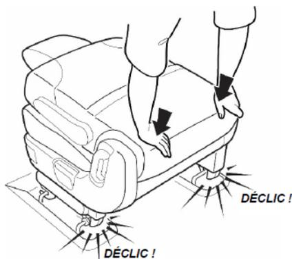
5. Relevez le dossier à une position redressée, puis balancez le siège d'en avant en arrière, en tentant de l'incliner vers l'avant afin de vous assurer que les loquets intérieurs et extérieurs sont verrouillés en position.
