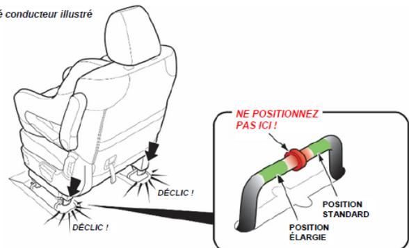
Si malgré les risques vous choisissez d'incliner tout le siège de la deuxième rangée vers l'avant pour accéder à la troisième rangée, assurez-vous que le siège est bien à la position standard ou élargie en abaissant et en verrouillant le siège.
