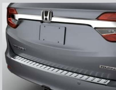
CAPTEURS DE RECUIL À L'ARRIÈRE
