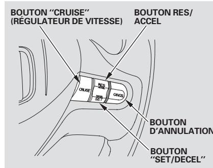
1. Enfoncer le bouton "CRUISE" sur le volant. Le témoin "CRUISE MAIN" s'allume sur le tableau de bord.
