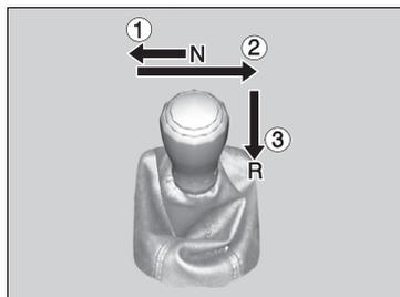
1. Enfoncer la pédale de débrayage, déplacer le levier de vitesses jusqu'à l'extrême gauche et mettre la boîte de vitesses en position **R**.
