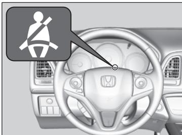
Le véhicule surveille l'utilisation des ceintures de sécurité avant. Si le commutateur d'allumage passe en position MARCHE **[II]**\*1 avant que la ceinture de sécurité du conducteur ne soit bouclée, le signal sonore retentira et le témoin clignotera. Si le conducteur ne boucle pas sa ceinture avant l'arrêt de l'avertisseur, le témoin restera allumé.
