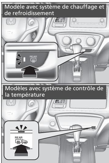
Appuyer sur le bouton du d  sembueur de lunette ou toucher l'ic  ne pour d  sembuer la lunette et les r  troviseurs lorsque le commutateur d'allumage est en position MARCHE **II**\*1.
