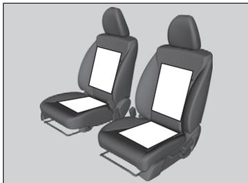
Le commutateur d'allumage doit être en position MARCHE **II**\*1 pour utiliser les chauffe-sièges. Le réglage HAUT réchauffe les sièges plus rapidement que le réglage BAS.
