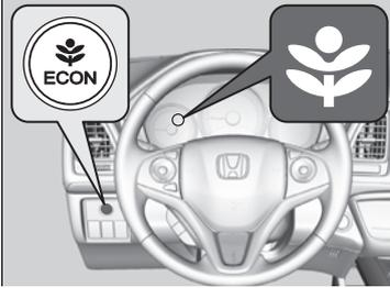
Le bouton **ECON** active et désactive le mode ECON. Le mode ECON aide à améliorer la cote de consommation en ajustant la performance du moteur, de la boîte de vitesses, du système de chauffage et de refroidissement\*/système de contrôle de la température\* et du régulateur de vitesse.
