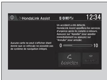
Si les coussins de sécurité gonflables se déploient ou si le système détecte que le véhicule a subi un choc important, le véhicule tentera automatiquement d'établir une connexion avec le service de téléphoniste HondaLink. Si la connexion est établie, l'information concernant le véhicule, son emplacement et son état seront envoyés au service de téléphoniste; il sera également possible de parler avec le/la téléphoniste une fois connecté.
