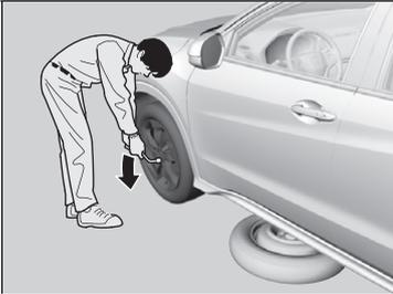
7. Desserrer chaque écrou de roue d'environ un tour en utilisant la clé pour écrou de roue.
