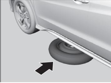
6. Placer le pneu de secours compact (roue vers le haut) sous la carrosserie du véhicule, près du pneu à remplacer.
